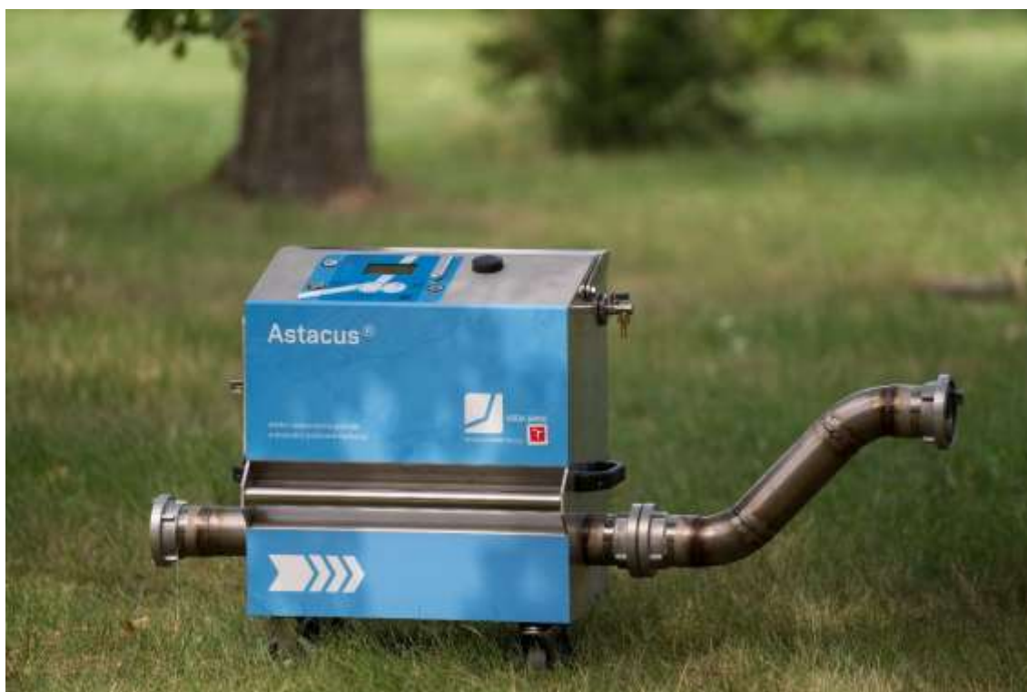
Obr. 8 Směr proudění vody strojem ve směru šipky (na obrázku zleva do prava). S-kus osadit na výstupní potrubí.
