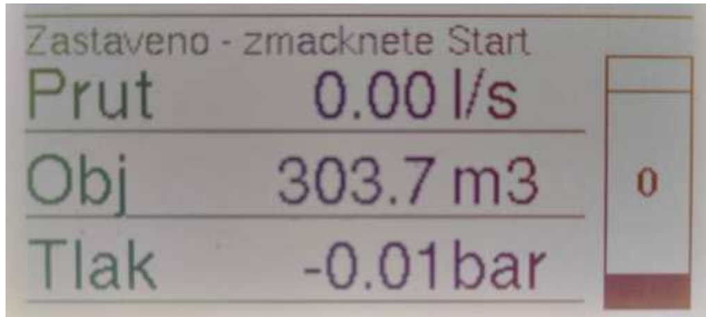
Obr. 9 Displej stroje Astacus při režimu programování – čekání na spuštění tlačítkem „Start“
