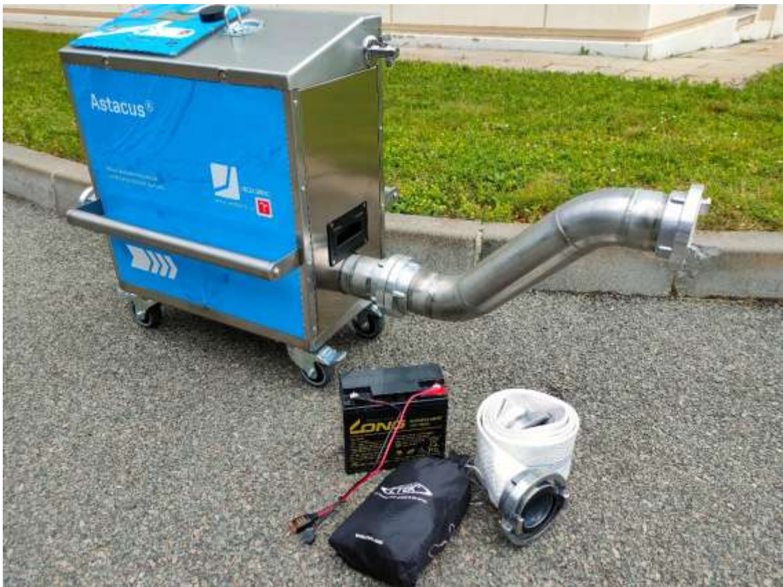
Obr. 2 Rozsah dodávky: stroj Astacus a příslušenství pro jeho funkci (S-kus, 2 m dlouhá hasičská hadice B75, dvě baterie 12 V 20 Ah a nabíječka baterií CTEK)
