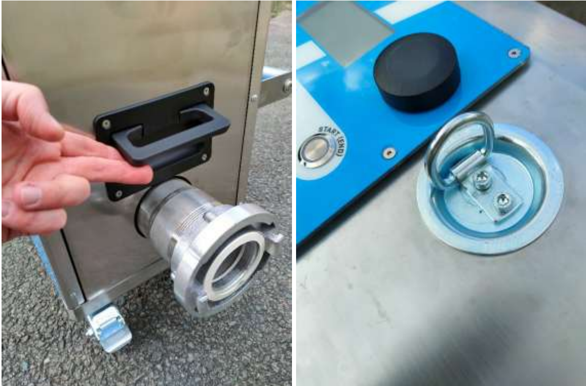
Obr. 4 Proplachovací robot Astacus (3. generace, 2024) – sklopné plastové madlo pro manipulaci se strojem (vlevo), sklopné ocelové kotevní oko pro zavěšení stroje na jeřáb.
