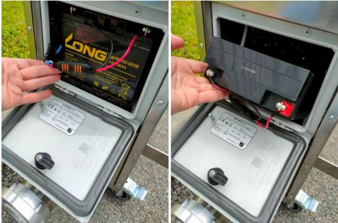
Obr. 6 Baterie 12 V 20 Ah s pojistkou a konektorem pro nabíječku CTEK (vlevo). Způsob správného vložení baterie (vpravo). Pozor na skřípnutí kabelů při zavírání dvířek!
