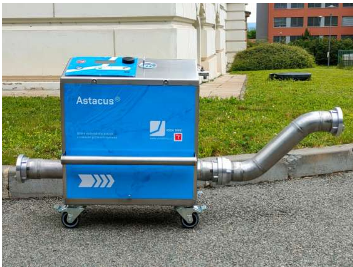
Obr. 10 Směr proudění vody strojem ve směru šipky. S-kus se osazuje na výstupní přírubu stroje.
