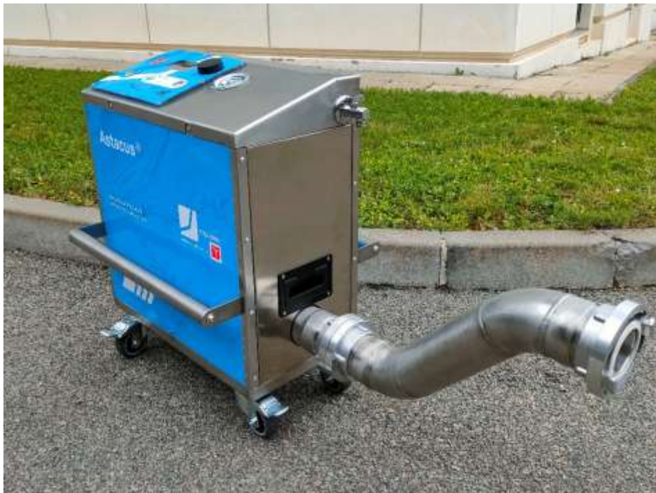
Obr. 1 Robot Astacus – stroj pro měření a řízené proplachování potrubí (3. generace, 2024)
